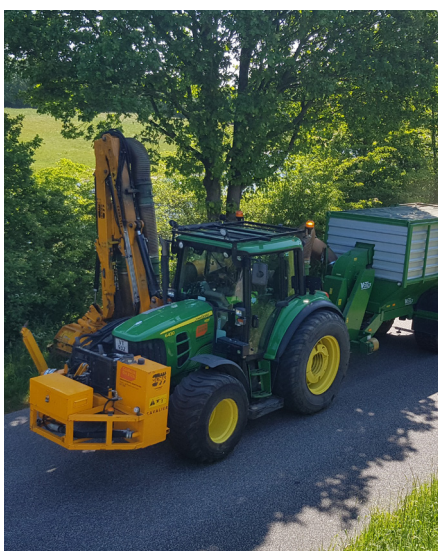
Slagleklipper med påmonteret opsug-ningsaggregat, der suger afklip op og fører det op i en påmonteret vogn. Rudersdal Kommune
