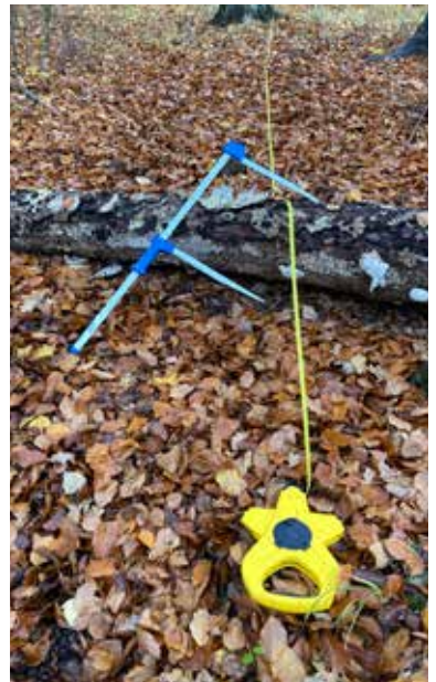
Redskaber til opmåling af dødt ved i forbindelse med de udlagte transekter Foto: RRH
